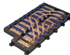
10 バックプレーンMT 角型コネクタにMTフェルールを組込み、 特殊なラック型シェルに取付
